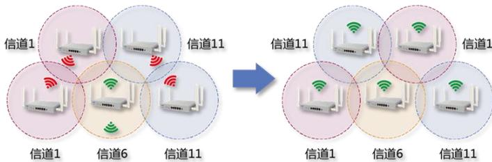
网月自组网产品具备自动判断周围是否存在同频信号干扰的功能，一旦探测到信号覆盖范围内的多个卫星之间存在干扰，则会自动进行调整，规避无线干扰。
