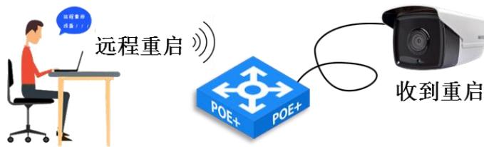
网月科技企业级 PoE+供电交换机具备强大的远程管理功能，使用网管计算机即可实现对设备的远程重启，大大提高设备维护效率。
