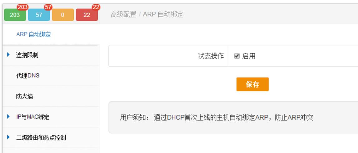
图 5.1 ARP 自动绑定
